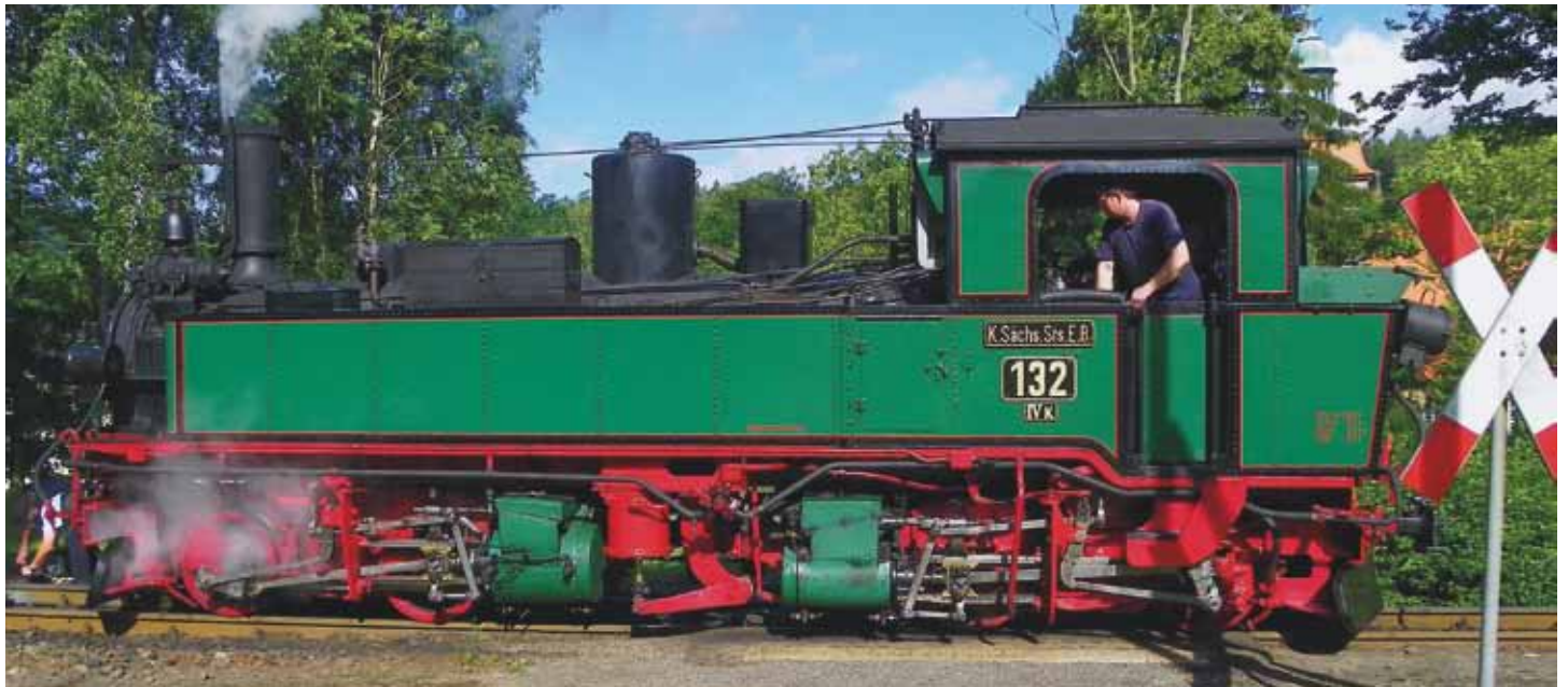
Lokomotiven der Bauart Meyer B'B' n4v, wie die 1899 von R. Hartmann in Chemnitz gebaute IV K 132, waren auf allen Schmalspurbahnen Sachsens anzutreffen. Über 20 Exemplare blieben, teils betriebsfähig, erhalten.
