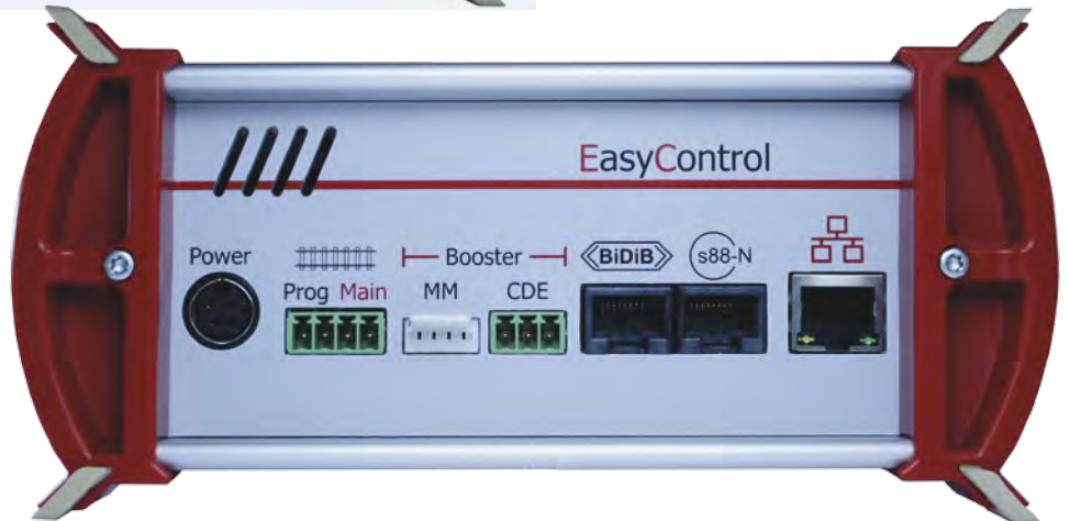
Die Rückseite der mc 2 mit Anschlüssen für die Stromversorgung, Haupt- und Programmiergleis, externe Booster (DCC-konform oder Märklinkompatibel), BiDiB und den s88-Bus und – last but not least – der LAN-Schnittstelle
