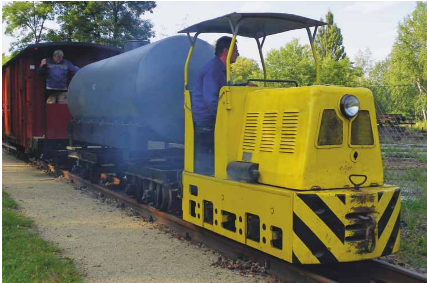
Eine tschechische BN 15 R mit einem restaurierten Säure-Tankwagen, wie er bis zuletzt im Feinpapierwerk Köbeln im Einsatz war. Die Lok verkehrte ursprünglich auf den Anschlussgleisen des Schaltgerätekwerkes Bad Muskau.
